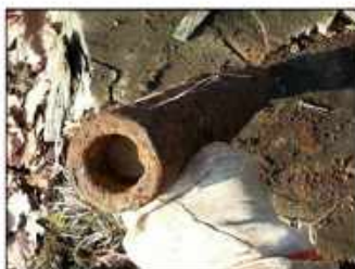
Țeavă MG151 cu un cartuş 15mm blocat pe ghinturi
