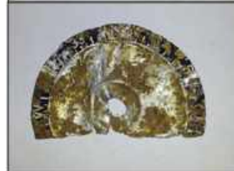
Cadran cap compas, din 3 bucăți Junkers Ju87 Stuka sau Bf 109
