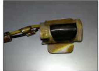
Lumină de navigație (cockpit) Me Bf109, DO217, Stuka JU 87 Nökel Bauart SH seria 126rr814 A-1
